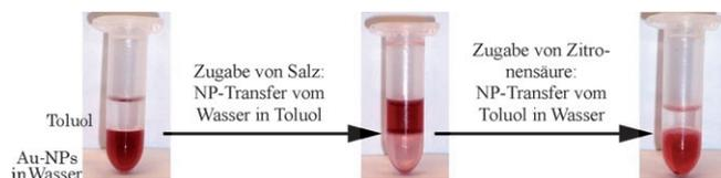
**In beide Richtungen:** Durch stimuliresponsive Bedeckung mit Polymerketten können Gold-Nanopartikel (Au-NPs) sowohl in wässrigen als auch organischen Medien kolloidal stabilisiert werden. In
