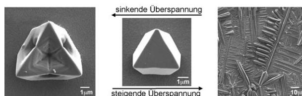
**Molekulare Bonsai:** Je nach Reaktionsbedingungen verläuft das Wachstum von  $Cu_2O$ -Kristallen über einen überspannungsbegrenzten (Bild links) oder einen konventionellen diffusionsbegrenzten
